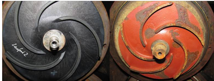
Fig. 3: Anche dopo 200 ore di funzionamento in presenza di cavitazione la nuova girante in vetroresina (a sinistra) dimostra la sua forte resistenza. La girante in ghisa grigia appare evidentemente danneggiata dalla cavitazione.
