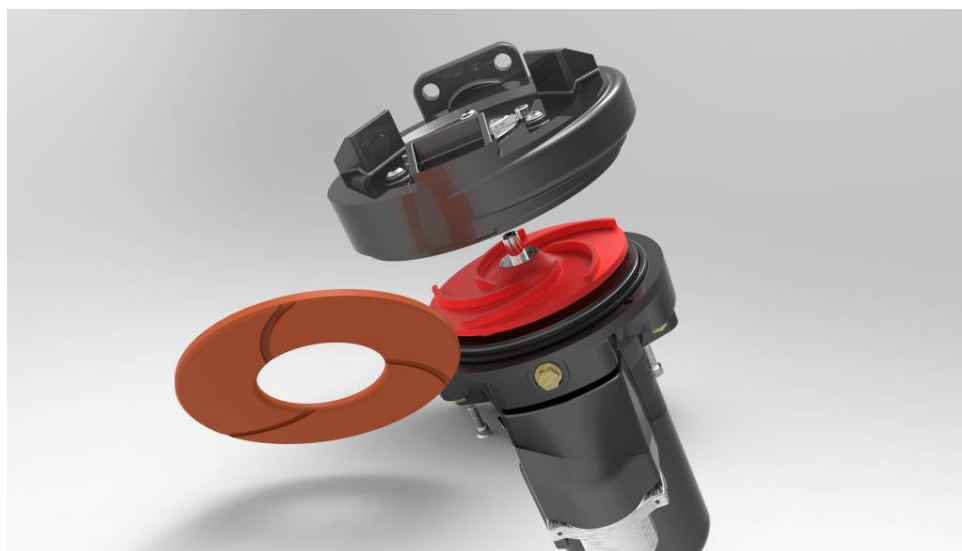
Fig. 2: La nuova girante (rossa) in vetroresina è notevolmente più resistente alla cavitazione. L'anello di usura (arancione) protegge l'alloggiamento a spirale ed è facilmente sostituibile.
